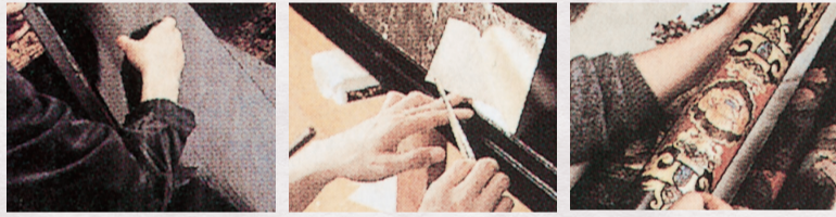
木地直し 虫食い、反りなどの不良部分を入念にチェック。完全修復いたします。 純金箔押し 細やかな心配りと高度な技術が純金箔の美しさをさらに引き立てます。 漆塗 新しいお仏壇を造るのと同じ工程で、漆刷毛で丹念に仕上げます。
